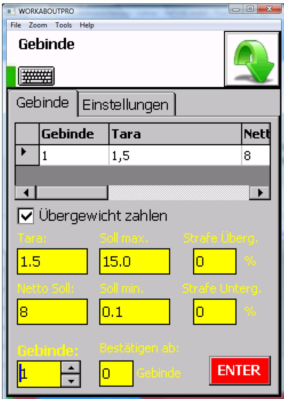
Wird **SoF.HiE mobil** in Verbindung mit einer Waage eingesetzt, so müssen Gebinde definiert werden, um z.B. verschiedene Tara realisieren zu können. Es folgen nun die einzelnen Einstellungsmerkmale:
